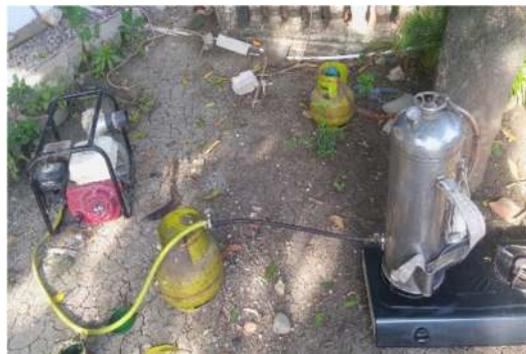
Gambar 2. Penggunaan limbah rambut kacang sebagai biofuel sumber energy penggerak mesin diesel
